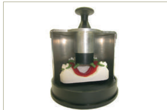
Abb. 10: Beispielbild. Seit der IDS 2015 wird von bredent eine neue Muffel für das Überpressen von Einbettmassemodellen angeboten. © bredent, Senden
