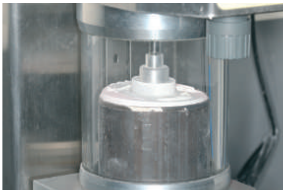
Abb. 14: Das Pressen des Gerüsts erfolgte im „for 2 press“-System.
